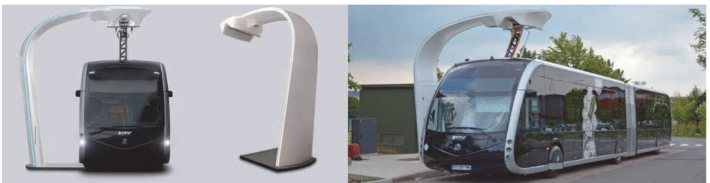
Figure 2 : bus NEMO avec le pantographe déployé
