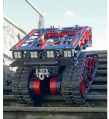
Figure 14 : le robot Colossus descendant un escalier
