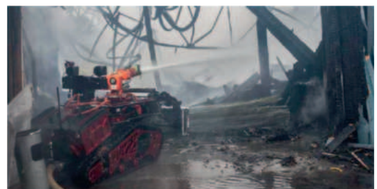
Figure 7 : Colossus version canon à eau + tourelle vidéo
