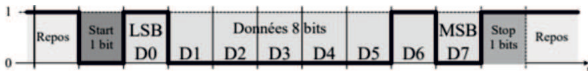
Figure 24 : transmission logique du caractère « A » sur 8 bits, 1 bit de stop.
